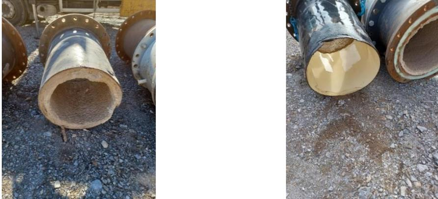
**Figura 8:** Antes y después de la aplicación de pulsos sónicos en una tubería de 600mm con incrustaciones de carbonato cálcico con un grosor de 9cm.
