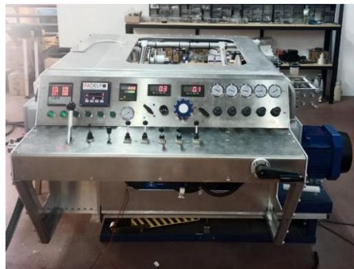
**Figura 5:** Panel de Control de presiones (izquierda) y Cabrestante de Operaciones (derecha).
